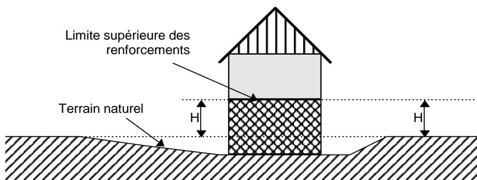
En cas de **terrassements en déblais**, la hauteur doit être mesurée par rapport au terrain naturel initial.
