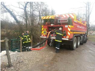
La prise d'aspiration d'eau pour la défense incendie réalisée cet automne au centre équestre a passé avec succès les tests de débit effectués par les pompiers de Parménie le 27 janvier dernier. Ces essais ayant été concluants une seconde prise d'eau similaire sera réalisée cette année au niveau du centre équestre du Centaure.
